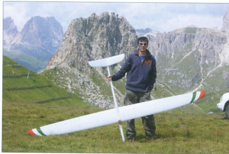
Selbst auf schnittigsten F3F-Modellen ist der GPS-Empfänger platzierbar. Auch wenn die Aerodynamik etwas leidet, konnte Lorenzo Scrignoli mit seinem »Wiking 2« über 320 km/h als gemessenen Wert im Bahnneigungsflug erzielen
