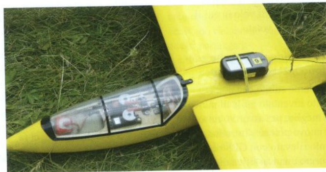
Il piccolo GPS da installare a bordo o esternamente sul modello. A sinistra: un lancio di gara e Marco Zaffaroni.
